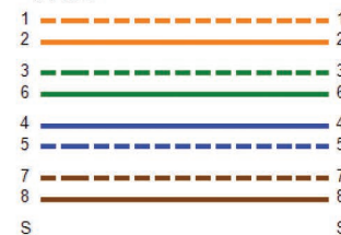
Схема разводки (T568B) PASS
